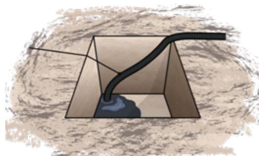
Рисунок: Осушение котлована
